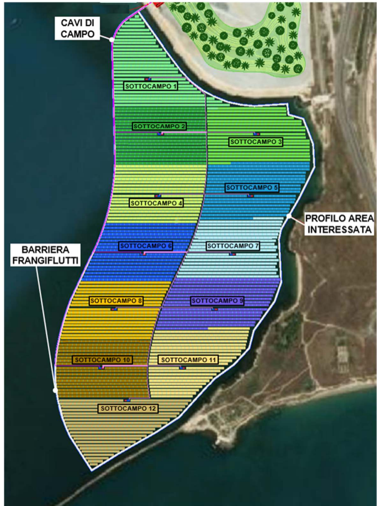
Figura 4.1 – Layout dell'impianto fotovoltaico. Elaborazione iLStudio.
