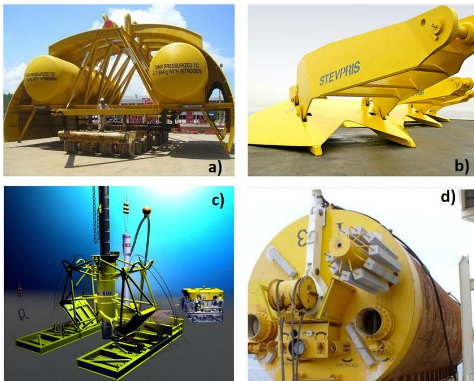
Figura 40 – esempio sistema TLP - Ancoraggio a) gravità; b) ancoraggio incorporato a trascinamento; c) ancoraggio a palo battuto; d) ancora di aspirazione Fonte <http://floatingwindfarm.weebly.com/stabilizing-systems.html>
