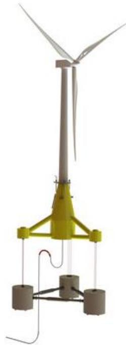
Figura 39 – esempio sistema TLP
