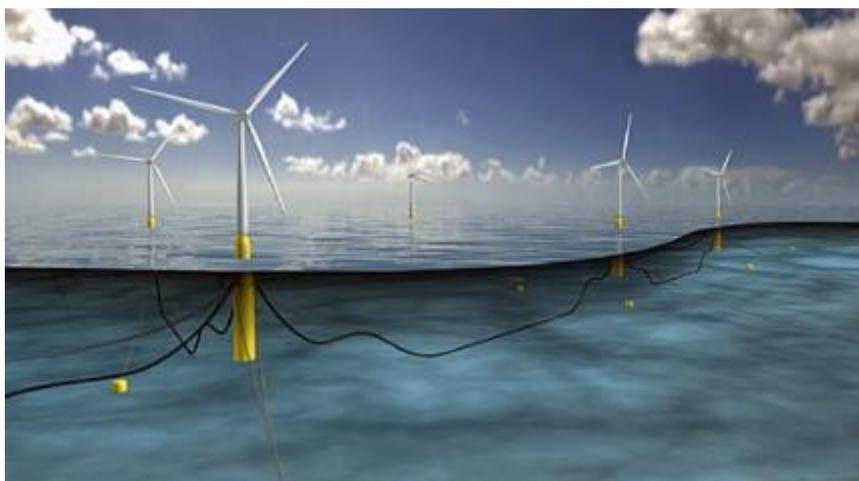
Figura 41 – esempio di cavo dinamico di collegamento tra gli aerogeneratori
