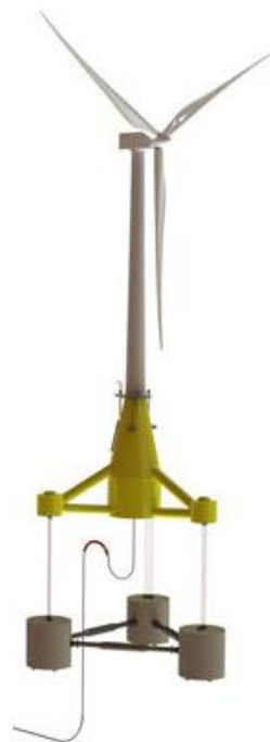
Figura 15 – Esempio sistema TLP
