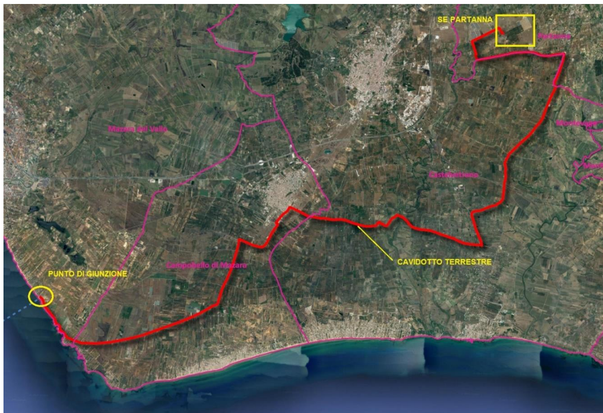
Figura 23 – Ipotesi di percorso cavidotto terrestre interrato
