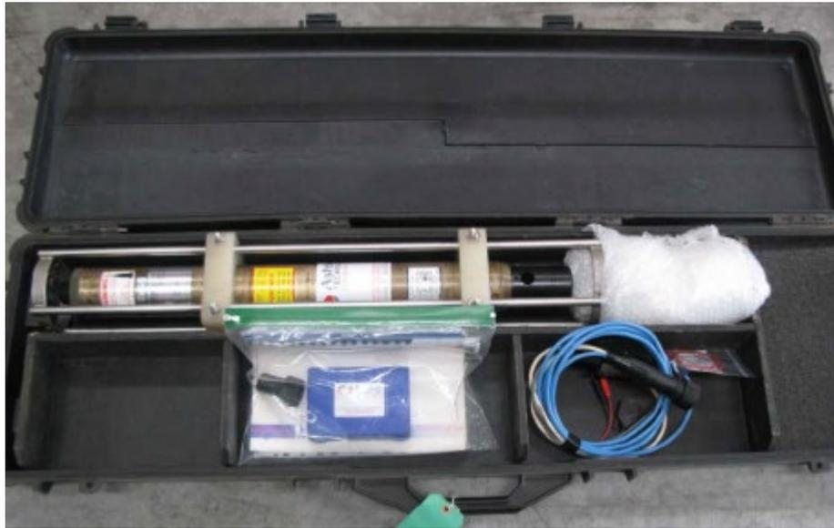
Figura 6 - Sonda multiparametrica tipo
