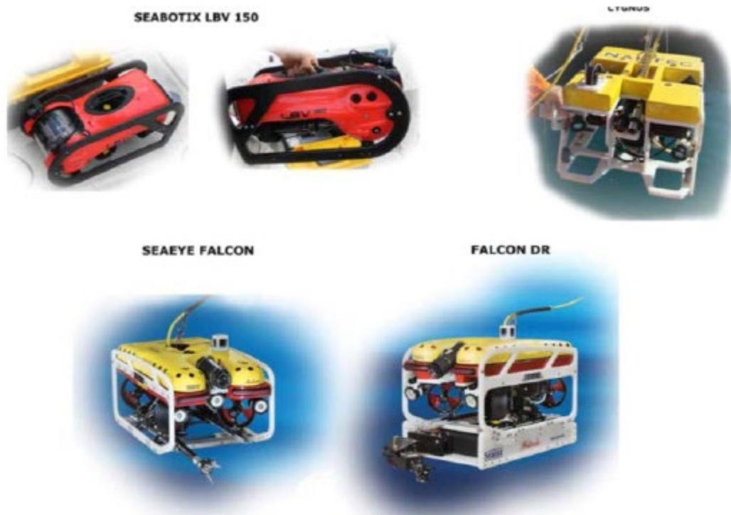
Figura 4 - Esempi di Veicoli filoguidati (ROV)
