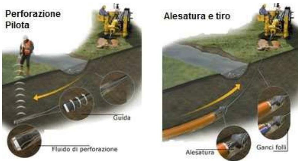
Figura 44 - Tecnologia di trivellazione orizzontale controllata (TOC)
