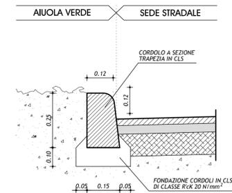
**SEZIONE TIPO IN ROTATORIA A CORSIA UNICA**
