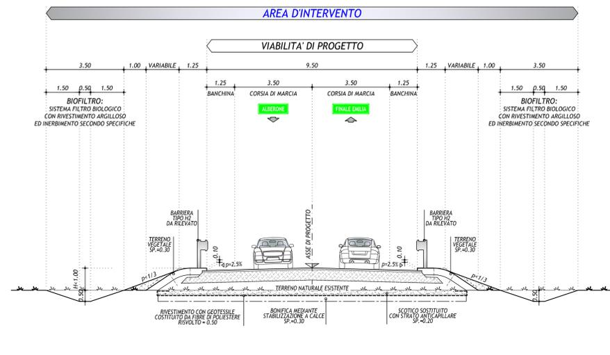
**VIABILITA' TIPO C2 : SEZIONE TIPO IN RISEZIONAMENTO**
