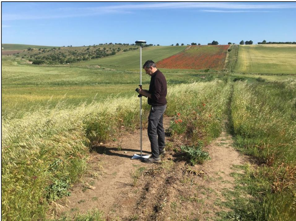
**Fig. 3.2.2.2 – Rilievo GPS in modalità RTK di un target nell'area di studio.**
