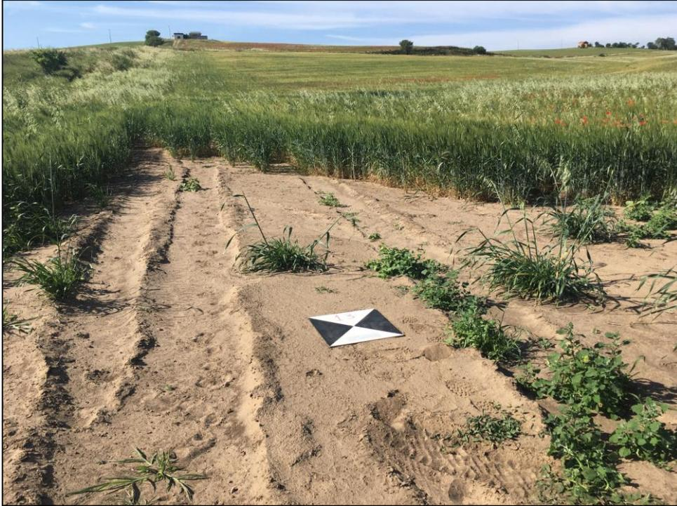
**Fig. 3.2.2.1 – Esempio di Target posizionato nell'area di rilievo**
