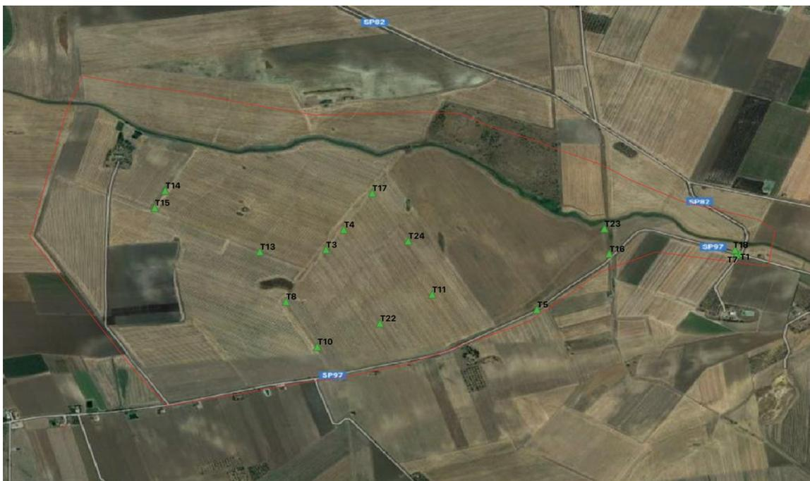
Fig. 3.2.2.5 – Proiezioni e codifica dei target rilevati (triangoli verdi) in ambienti GIS-QGIS all'interno del perimetro del piano di volo ( limite rosso).
