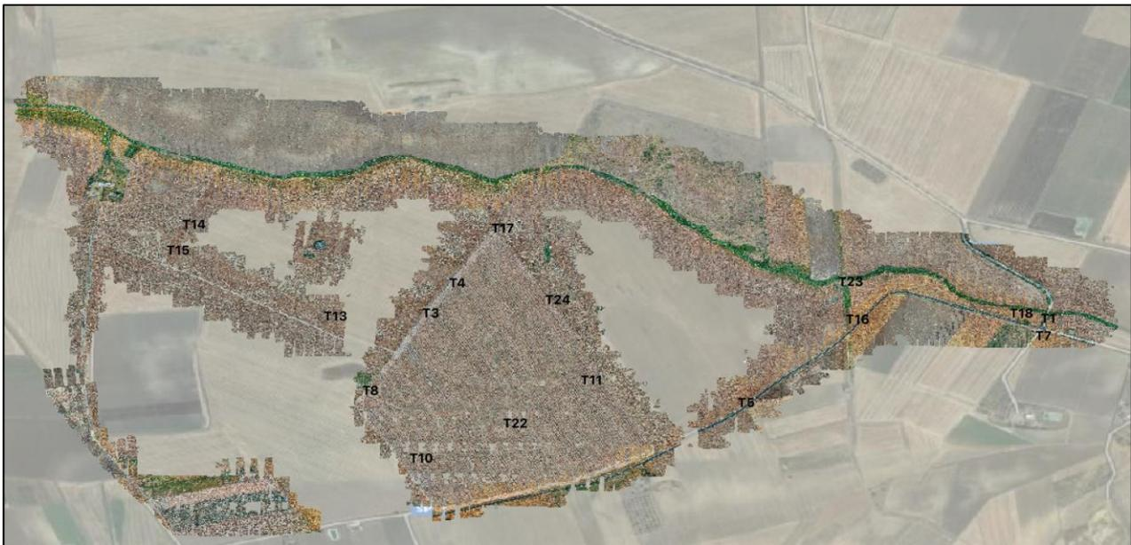
**Fig. 3.2.4.1** Nuvola di punti RGB “densa” estratta durante le fasi di post-elaborazioni, sovrapposta a immagine di Google Maps, in evidenza i target di precisione rilevati
