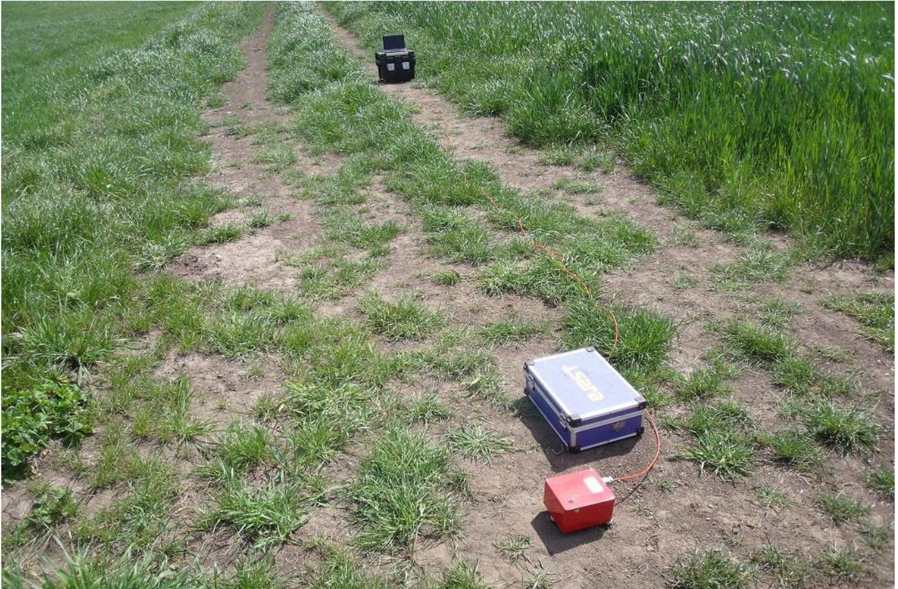
Foto 15 – Prospezione sismica HVSR 1
