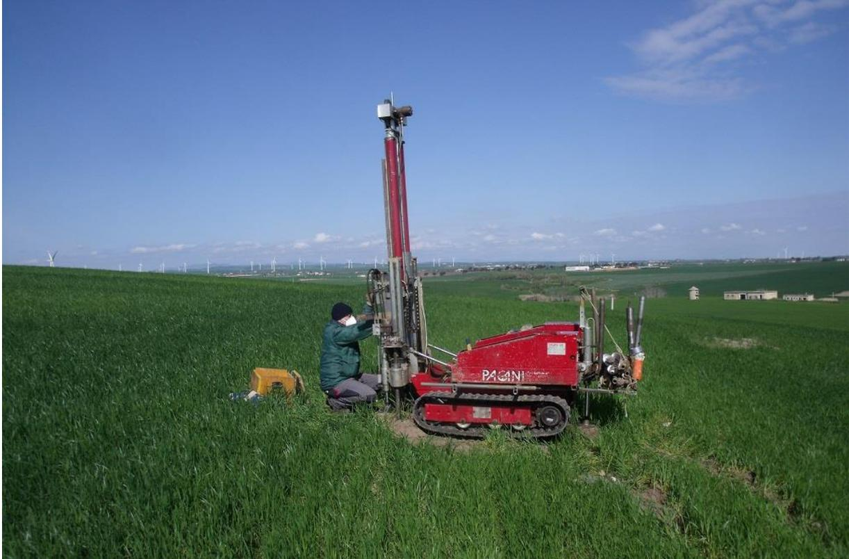
Foto 11 – Prova Penetrometrica CPT 11
