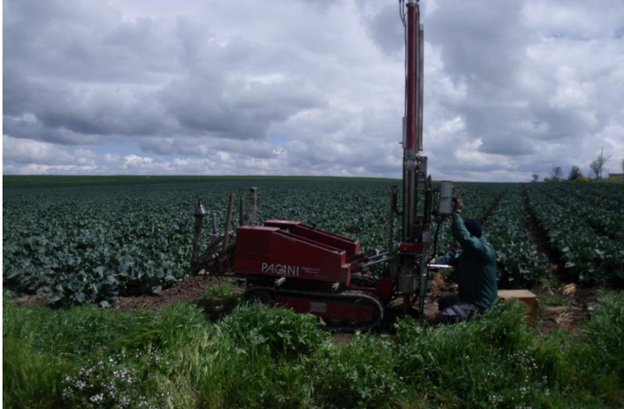
Foto 7 – Prova Penetrometrica CPT 7
