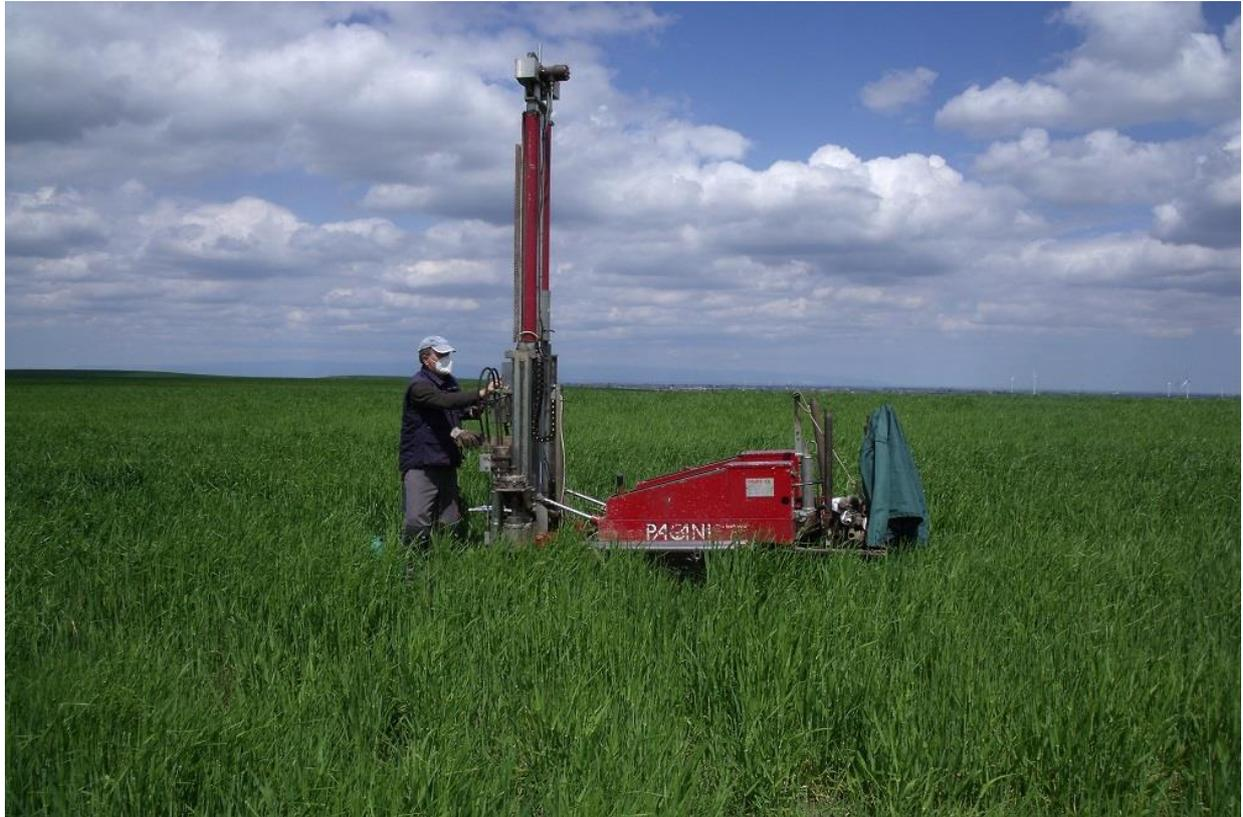
Foto 6 – Prova Penetrometrica CPT 6
