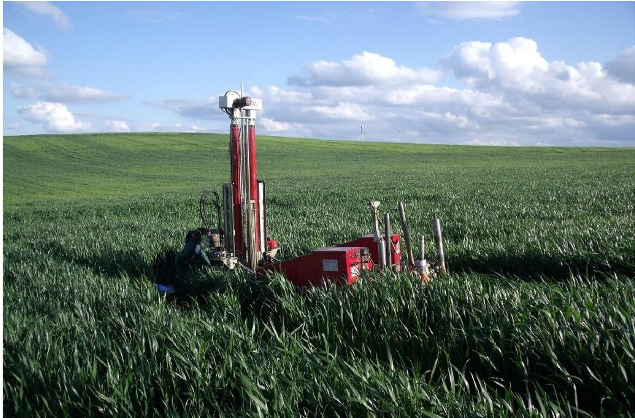
Foto 10 – Prova Penetrometrica CPT 10
