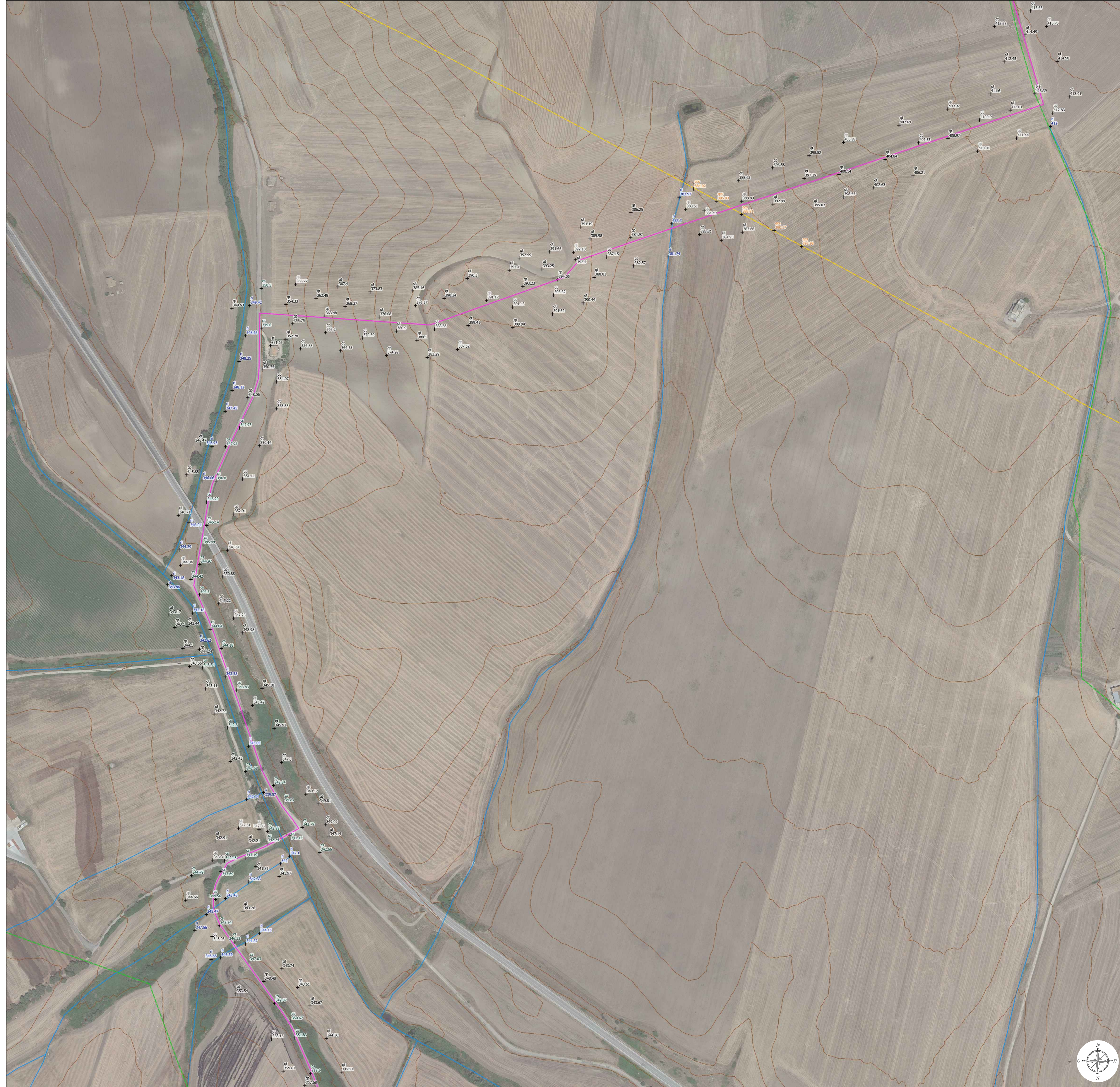
Cavidotto - Rilievo Planoaltimetrico - Scala 1:2000
