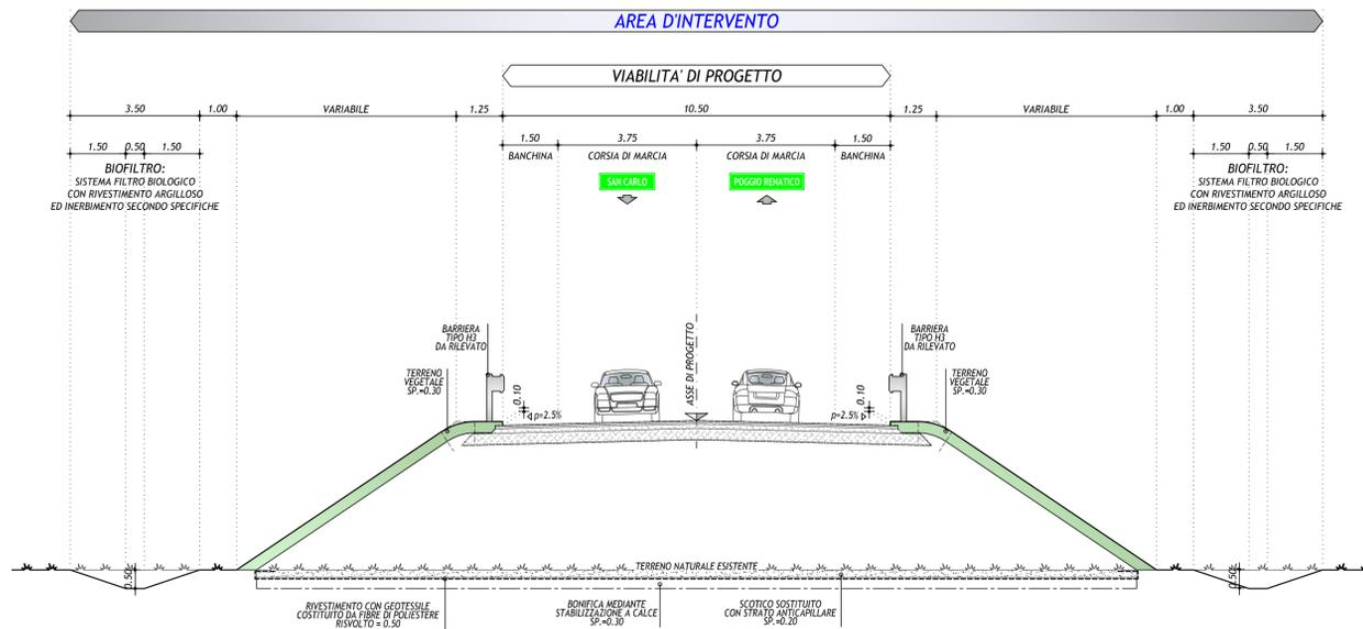
**SEZIONE TIPO IN ROTATORIA**
