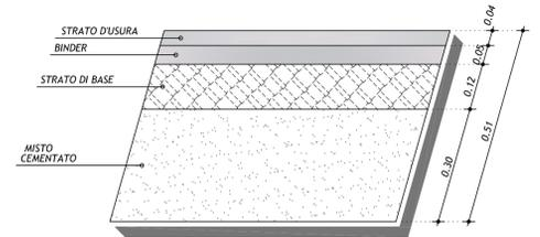
**SEZIONE TIPO IN RETTIFILICO CON RILEVATO H>2.50m**
