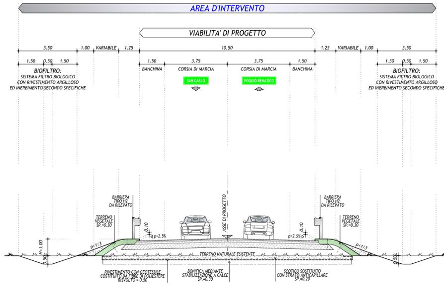
**SEZIONE TIPO IN RETTIFILICO IN RISEZIONAMENTO**
