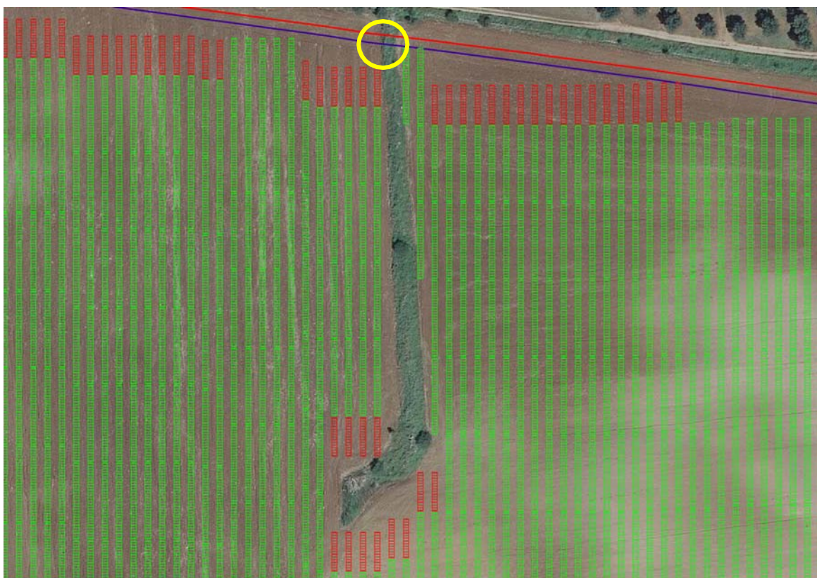
Muretto a secco nel Campo A non interessato direttamente dall'impianto, se non nel tratto a Nord, per 3,5 m circa presso la recinzione (cerchio giallo)
