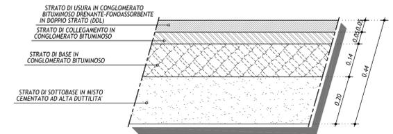
SEZIONE TIPO IN RETTIFILLO CON RILEVATO H<2.50m
