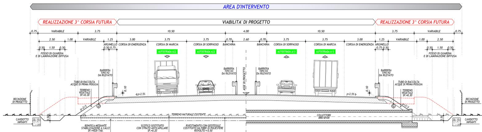
SEZIONE TIPO IN CURVA CON RILEVATO H<2.50m
