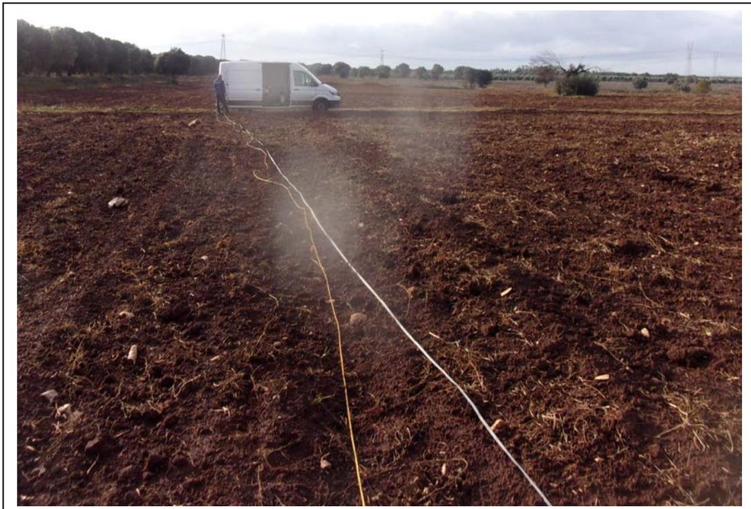
Esecuzione profilo sismico a rifrazione e remi sullo stesso stendimento
