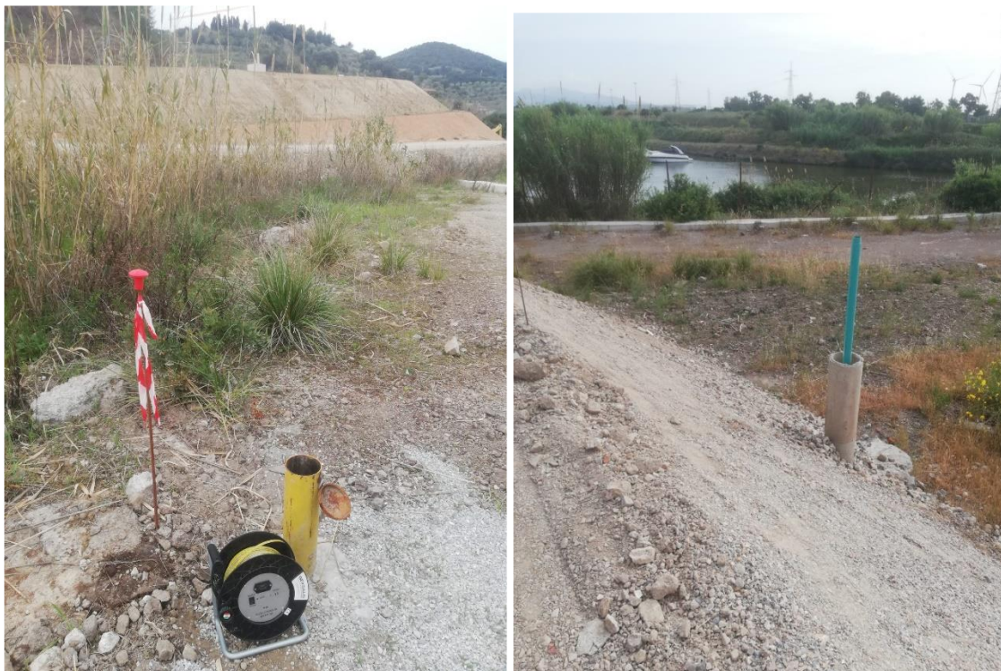
Figura 11 Variazione della quota del boccapozzo del piezometro AST10 dalla campagna di marzo (foto sx) alla campagna di maggio (foto dx).
