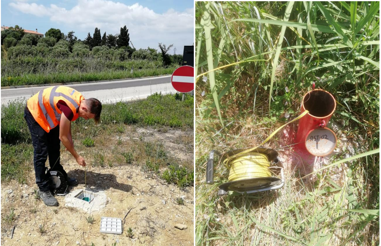
Figura 4 – Punti di monitoraggio acque sotterranee AST01 – AST02
