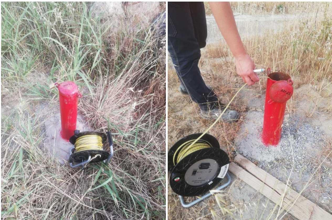
Figura 9 Punti di monitoraggio acque sotterranee AST11 – AST12
