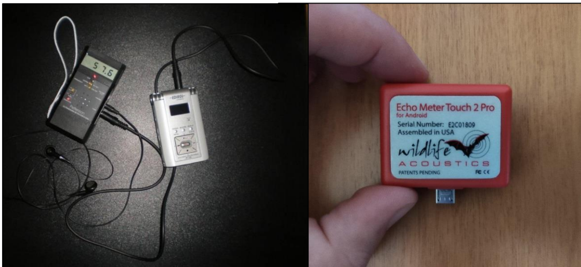
Foto 5.2.A – Bat detector D240X con registratore digitale Edirol R-09 e Echo Meter Touch 2 Pro
