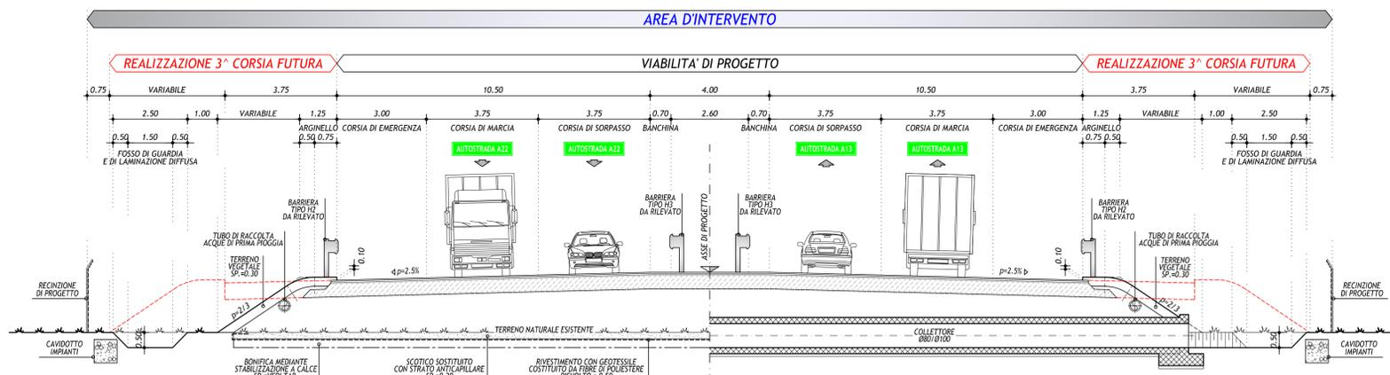
SEZIONE TIPO IN RETTIFILLO CON RILEVATO H<2.50m
