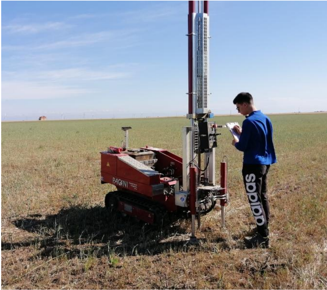
ESECUZIONE PROVA PENETROMETRICA
