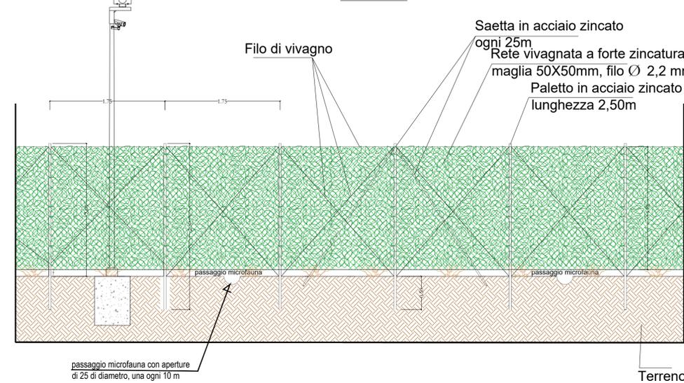
passaggio microfauna con aperture di 25 di diametro, una ogni 10 m
