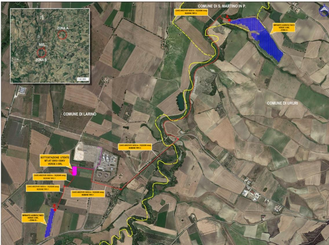
Fig. 24 – Veduta aerea con indicazione, in rosso, dei tracciati dei cavidotti.
