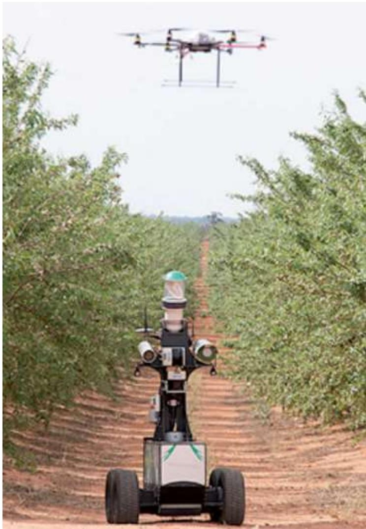
Esistono testimonianze di aziende che impiegano nella gestione delle proprie coltivazioni sofisticati kit dotati di sensoristica avanzata, con batterie ad alimentazione solare, che dispongono di sensori ambientali-vegetazionali e meteorologici. I kit si compongono di un sistema di water intelligence che misura in tempo reale le necessità idriche delle coltivazioni, nonché di un pannello di monitoraggio – web o su mobile app – per verificare in autonomia lo stato idrico delle piante.
