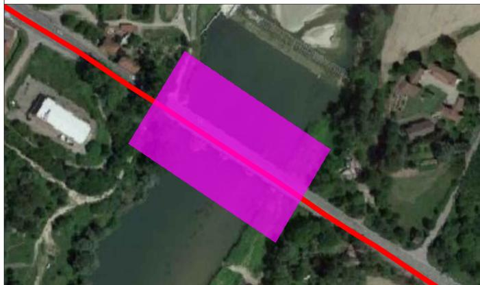
L'attraversamento del fiume Bormida avverrà mediante posa dei cavidotti sottostrada a profondità ribassata. La posa degli stessi avverrà all'interno di bauletto in cls.
