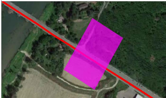
Lungo il lato Nord della carreggiata della SR10 è presente una rete idrica comunale (in giallo). In caso di parallelismi, il cavidotto MT andrà posizionato ad una distanza di almeno 0,3 m misurati sulla proiezione in pianta dalla rete idrica.
