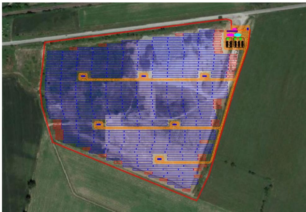
Figura 1 – Layout del sottocampo "Guarasca". In corrispondenza dello spigolo nord-est è previsto l'impianto di accumulo elettrochimico
