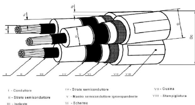
**Figura 14 – Cavo utilizzato per i cavidotti MT di connessione alla rete**
