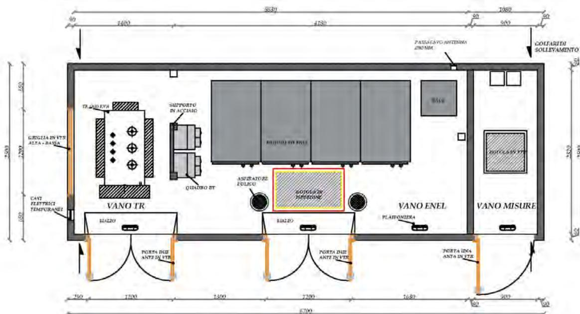
Figura 11 – Vista in pianta della cabina di consegna DG 2092 rev3.
