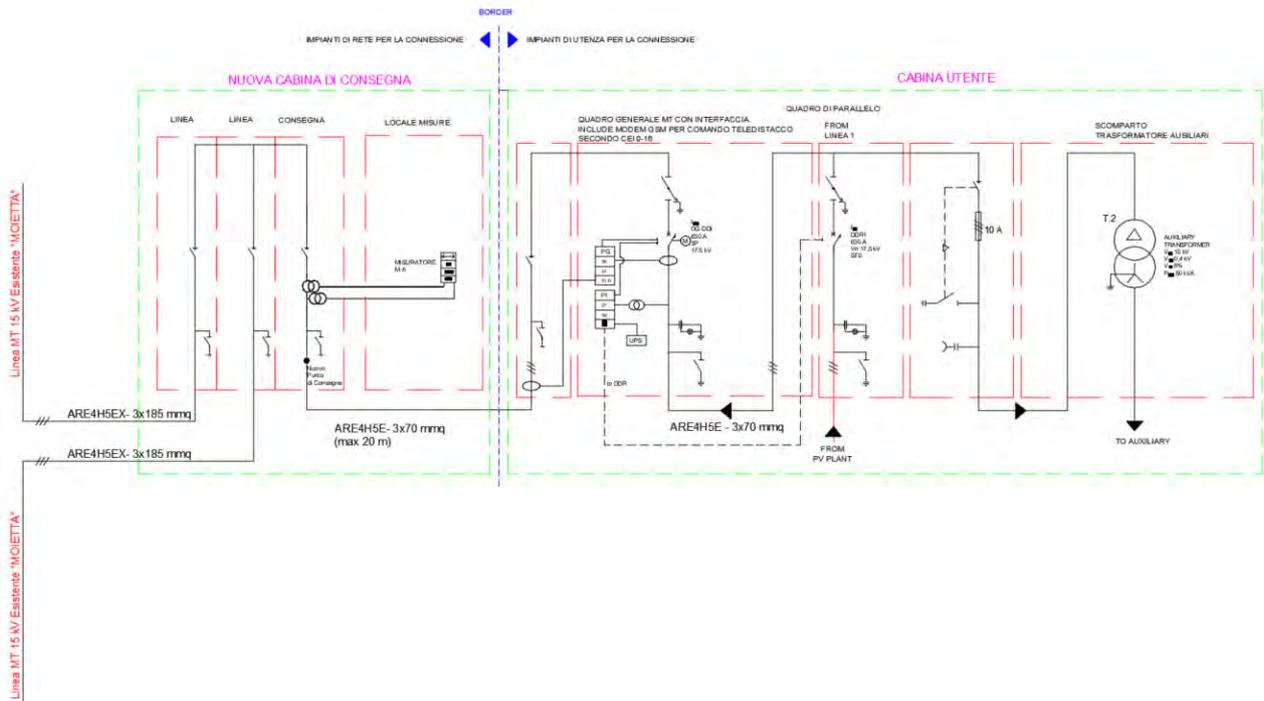
**Figura 12 – Schema elettrico unifilare di connessione alla rete**
