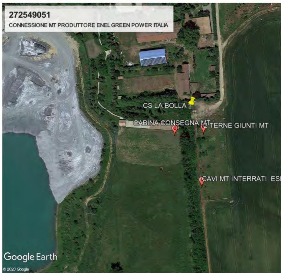
**Figura 7 – Ubicazione cabina di consegna e tracciato cavidotti di connessione alla CP Pietrafitta secondo planimetrie STMG**
