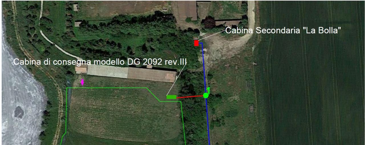
**Figura 9 – Tracciato dei cavidotti di connessione alla rete (in rosso).**
