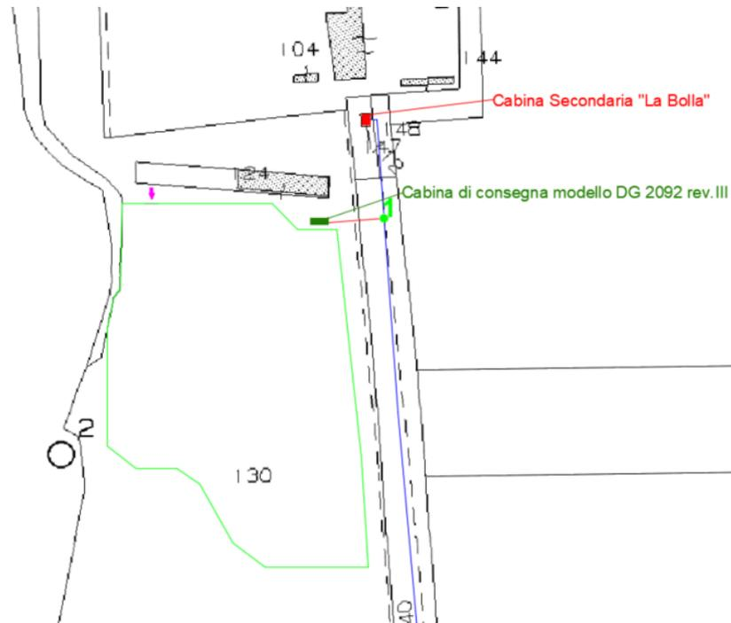
Figura 4 - Estratto di mappa Catastale con indicazione punto di connessione
