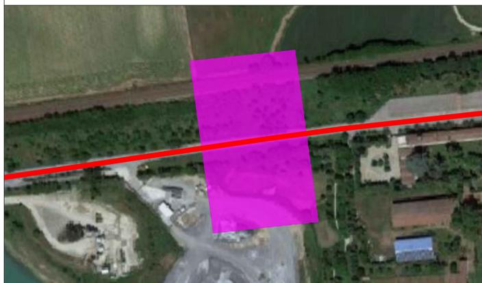
Il tracciato del cavidotto MT di connessione alla rete interferisce con attraversamento della strada da parte del Rio Bolla. Il cavidotto seguirà l'infrastruttura esistente e ne verrà previsto lo staffaggio sulla spalla del ponte. In alternativa, nel caso in cui lo staffaggio non sia possibile, verrà impiegata in fase di progettazione esecutiva soluzione tecnica tramite attraversamento in subalveo in TOC del Rio Bolla.
