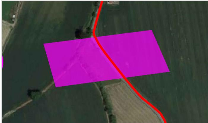
Il tracciato dei cavidotti MT di connessione alla rete interseca un **metanodotto** (in giallo nell'immagine a lato) di cui non sono note le modalità e profondità di posa. La distanza minima misurata in verticale tra le superfici affacciate dei cavidotti e del metanodotto non deve essere inferiore a 1,5 m.
