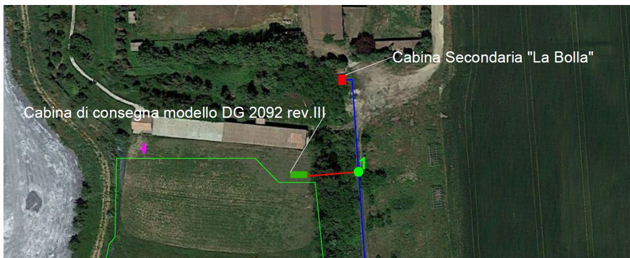
Figura 20 – Tracciato dei cavidotti di connessione alla rete del sottocampo “La Bolla” (in rosso).
