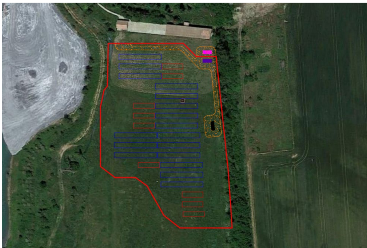
Figura 3 - Layout di impianto con sovrapposizione su ortofoto, sottocampo "La Bolla"
