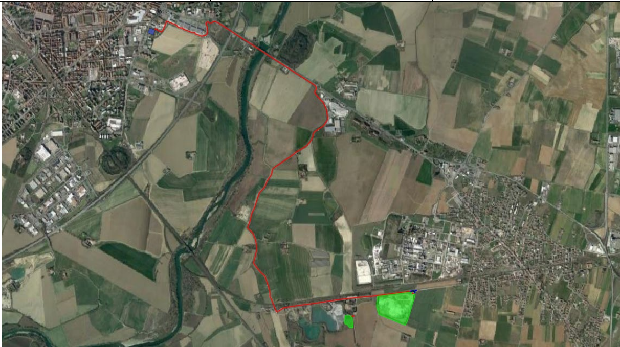
Figura 11 – Inquadramento su Google Earth dell’impianto. In verde l’area interessata dall’impianto FV, in rosso i cavidotti relativi alle opere di connessione alla rete.
