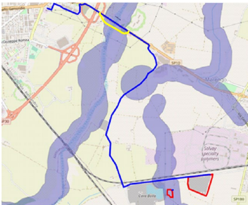
Figura 16 – Inquadramento dell’area di impianto (in rosso), il tracciato dei cavidotti (in blu) e l’attraversamento alternativo del fiume Bormida mediante TOC (in giallo) sulla carta dei beni paesaggistici (fonte: SITAP – Ministero Beni Culturali)
