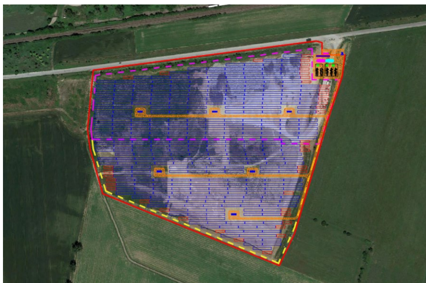
Figura 26 – Layout di impianto con sovrapposizione su ortofoto, sottocampo "Guarasca". In magenta la demarcazione del Lotto A, in giallo la demarcazione del lotto B.
