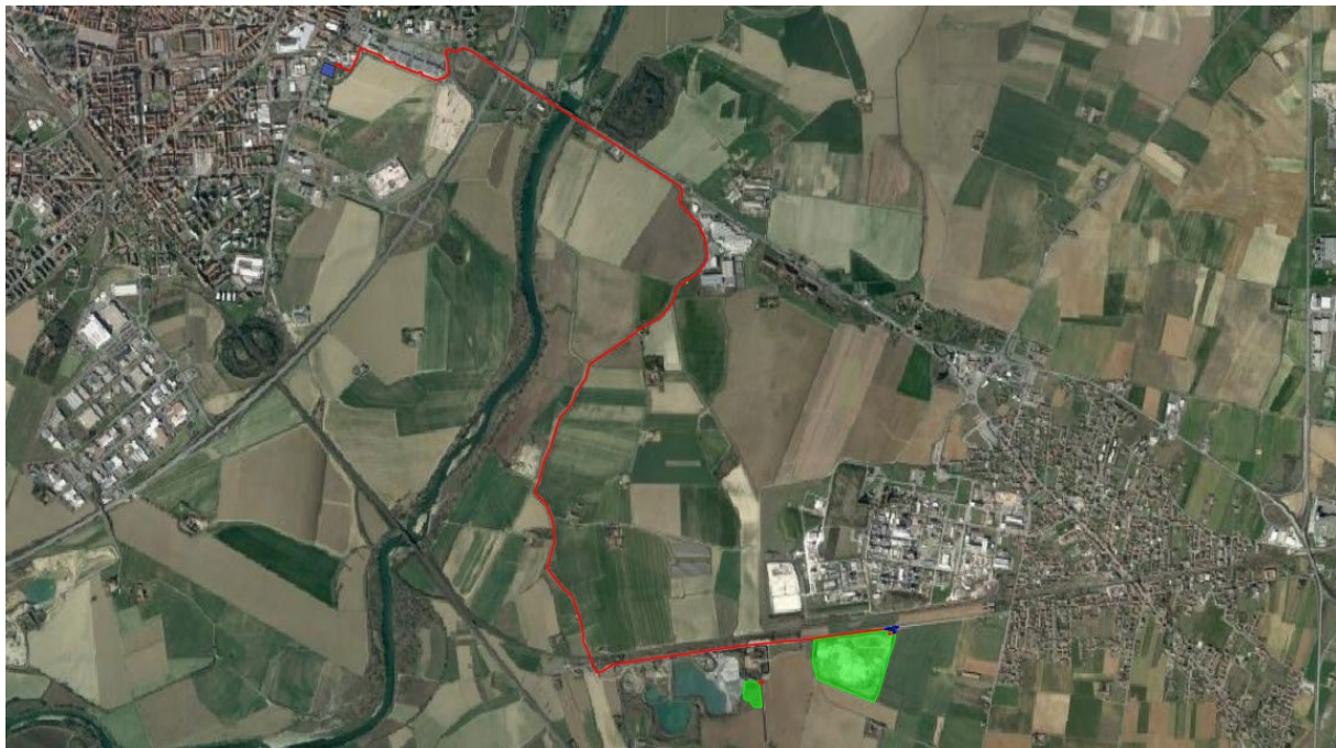
Figura 4 – Inquadramento su Google Earth dell'impianto. In verde l'area interessata dall'impianto FV, in rosso i cavidotti relativi alle opere di connessione alla rete.
