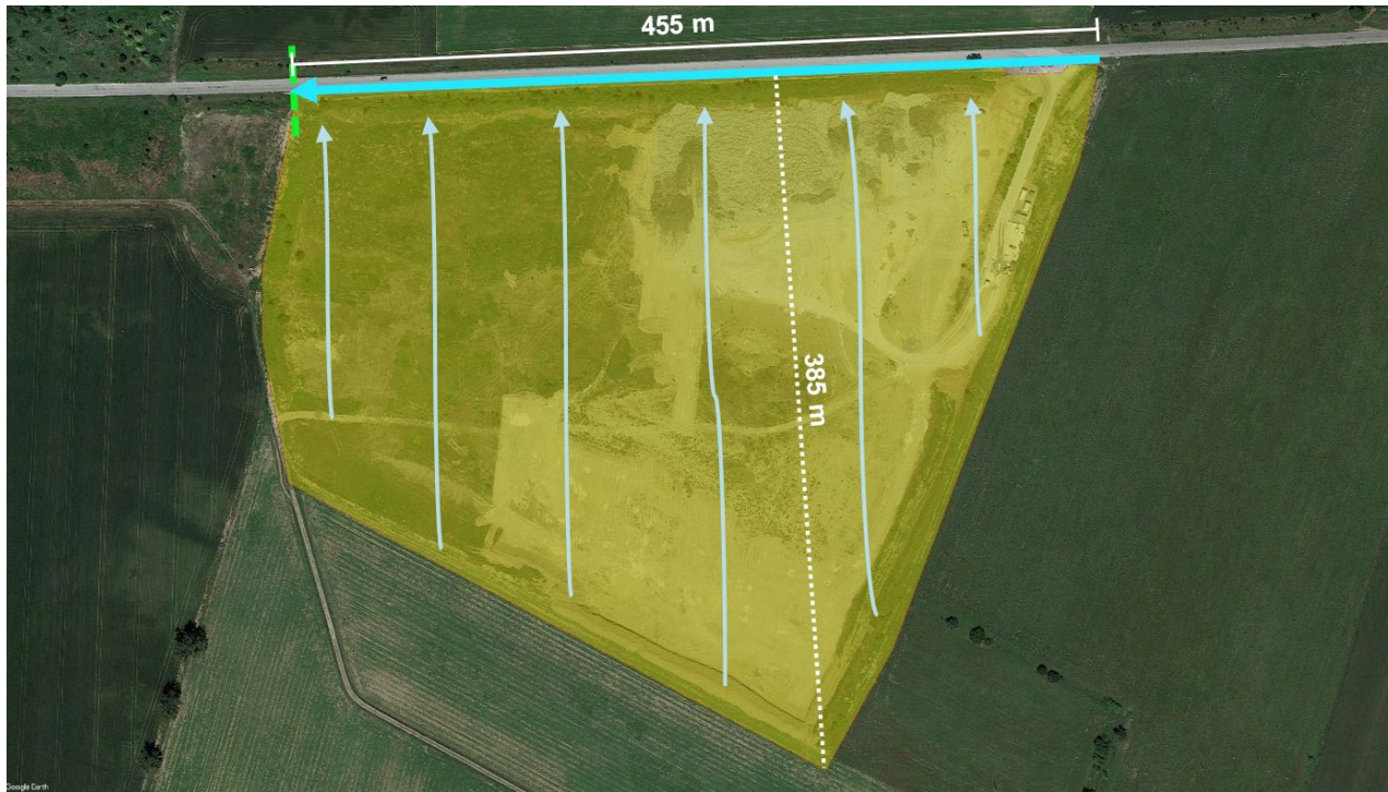
Figura 17: Schema di massima di regimentazione delle acque meteoriche nel lotto "Guarasca".
