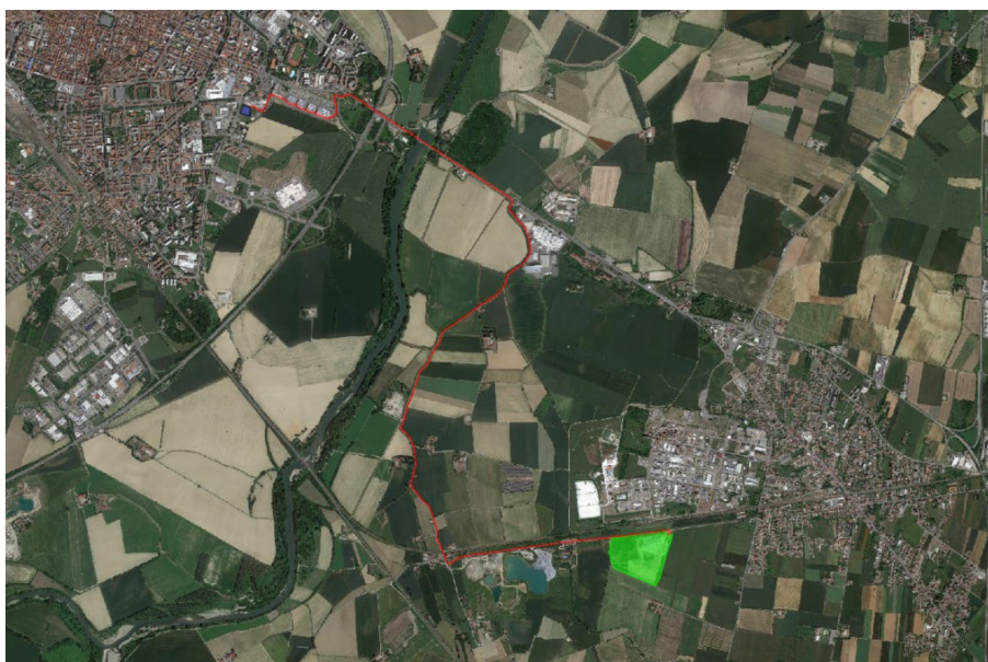
Figura 1 - Inquadramento su Google Earth. In verde l'area "Guarasca", in rosso il tracciato dei cavidotti relativi alle opere di connessione alla Cabina Primaria "Alessandria Sud".
