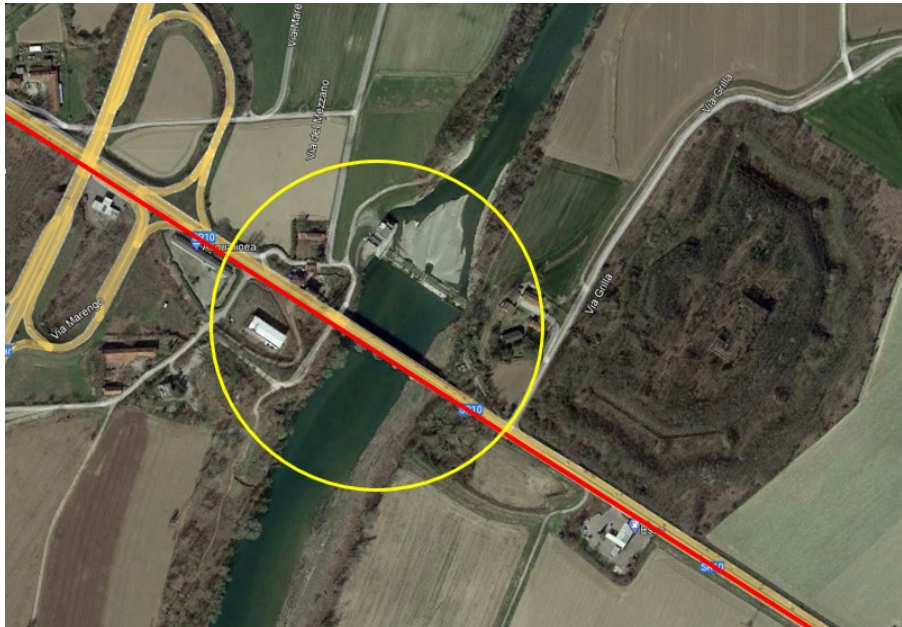
Figura 6 – Punto di attraversamento del fiume Bormida lungo la SR10. In rosso il tracciato dei cavidotti.
