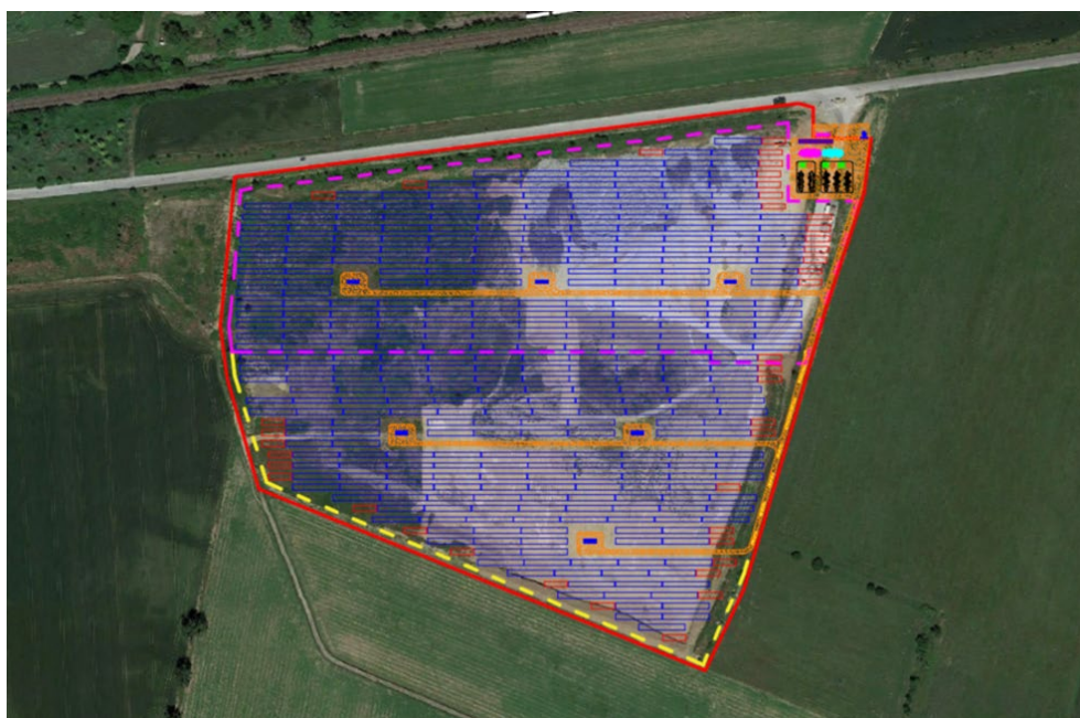
Figura 42 – Layout di impianto con sovrapposizione su ortofoto, sottocampo “Guarasca”. In magenta la demarcazione del Lotto A, in giallo la demarcazione del lotto B.
