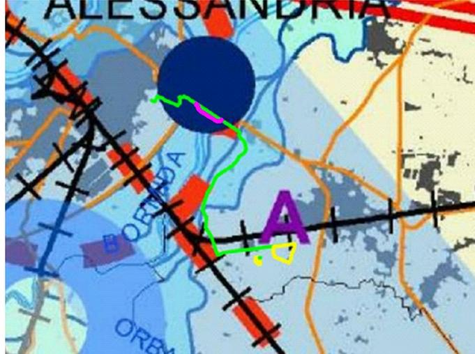
Figura 13 – Inquadramento dell’area di impianto (in giallo), il tracciato dei cavidotti (in verde) e l’attraversamento alternativo del fiume Bormida mediante TOC (in magenta) sulla “Tavola di Progetto” del PTR
