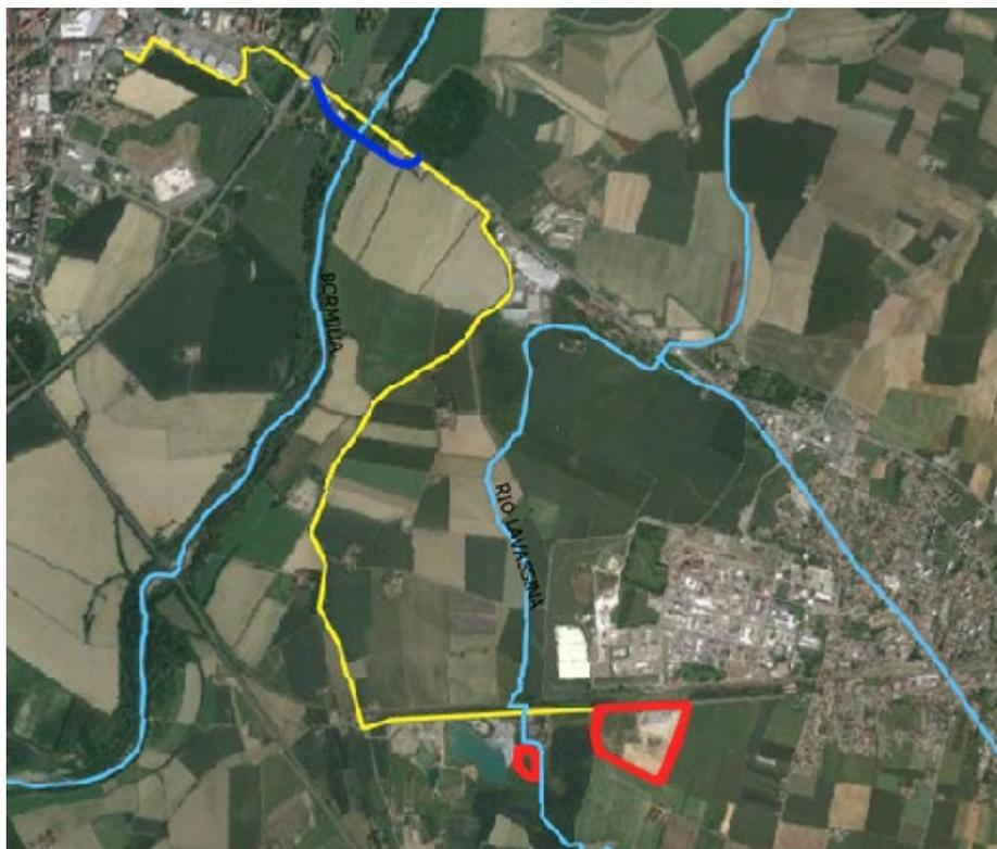
**Figura 61 –Ubicazione dell’area di progetto (in rosso), del tracciato del cavidotto (in giallo) e l’attraversamento alternativo del fiume Bormida mediante TOC (in blu) rispetto al reticolo idrografico (in azzurro) (Fonte: ARPA Piemonte)**
