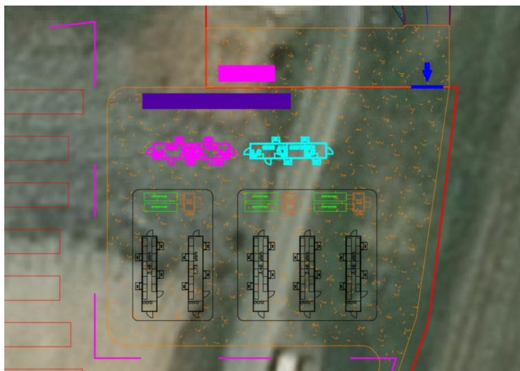
**Figura 44 – Dettaglio su area BESS all'interno del sottocampo "Guarasca" e identificazione del Lotto 1 e del Lotto 2**
