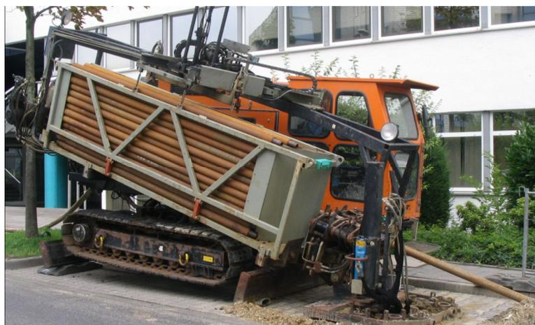
*Figura 2. Perforatore orizzontale*
