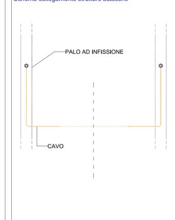
Schema di collegamento struttura a dorsale di terra
