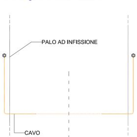
Schema di collegamento struttura a dorsale di terra
