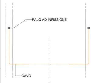
Schema di collegamento struttura a dorsale di terra
