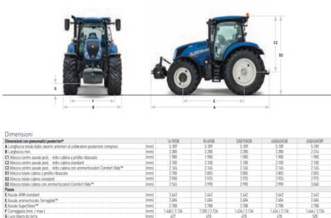
Figura 11: Dimensioni dei trattori gommati convenzionali prodotti dalla New Holland Serie 7.6
