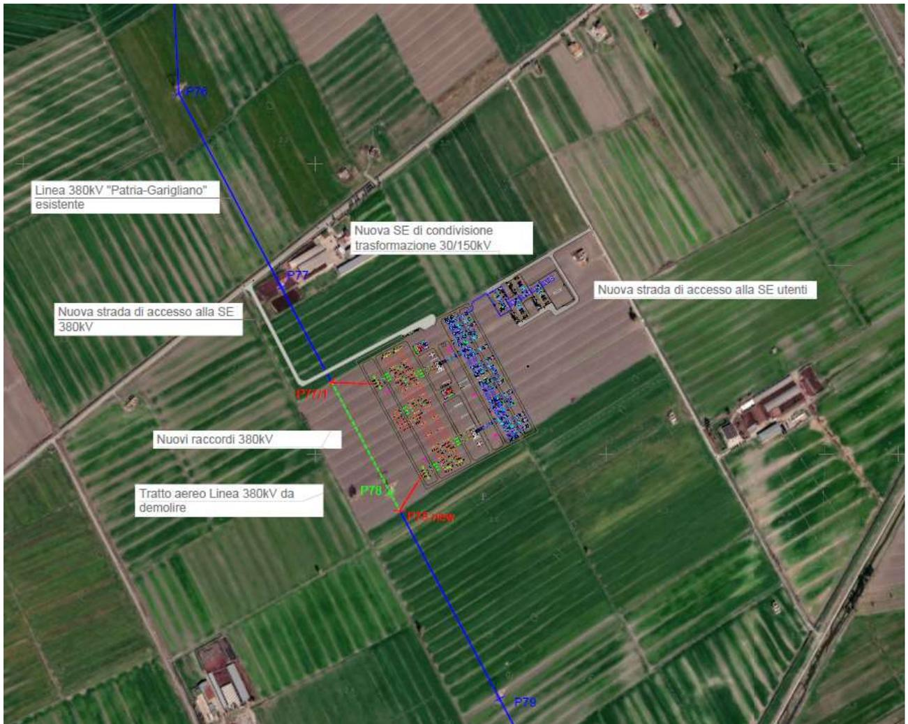
Figura 1:Ortofoto della nuova SE RTN 380/150 kV (a sinistra) e SE di condivisione/trasformazione 30/150 kV
