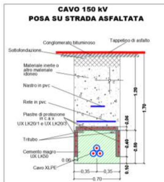
Figura 2: Posa cavo 150 kV "SE 30/150 kV – SE "Cancello 380"
