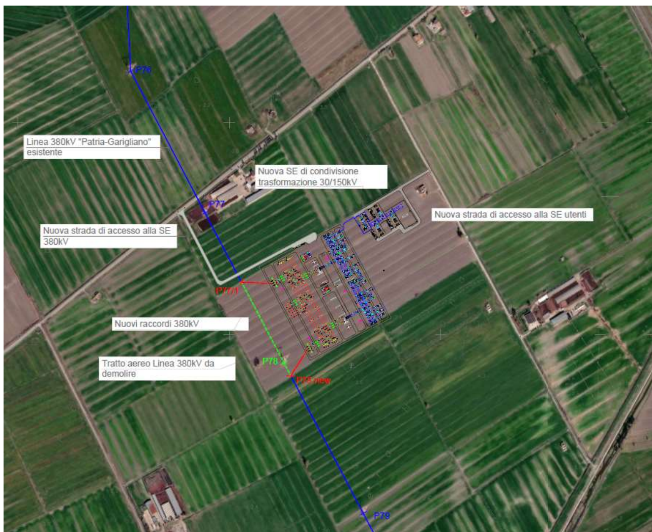
Figure 1: Ortofoto della nuova SE RTN 380/150 kV (a sinistra) e SE di condivisione/trasformazione 30/150 kV
