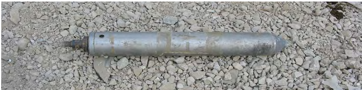
Campionatore nella posizione di infissione a pressione
