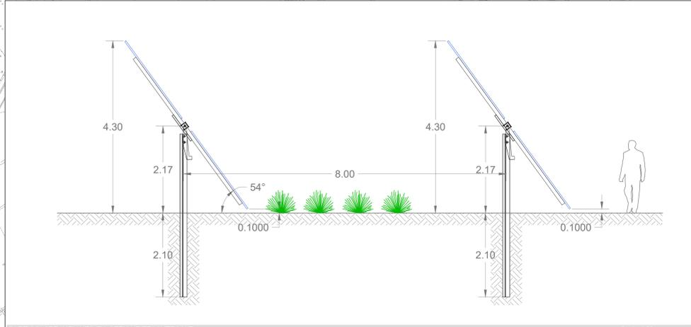
PARTICOLARE IMPIANTO FV: SEZIONE TRASVERSALE
