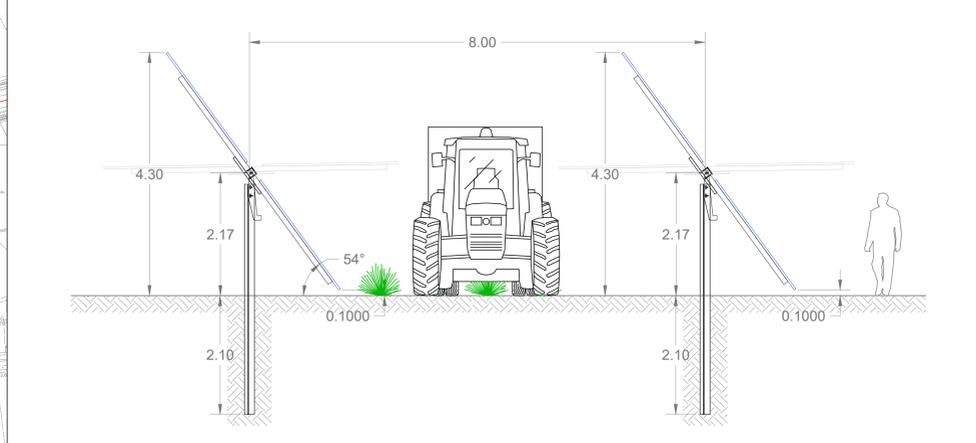
PARTICOLARE IMPIANTO FV: SEZIONE TRASVERSALE CON TRATTORE GOMMATO
