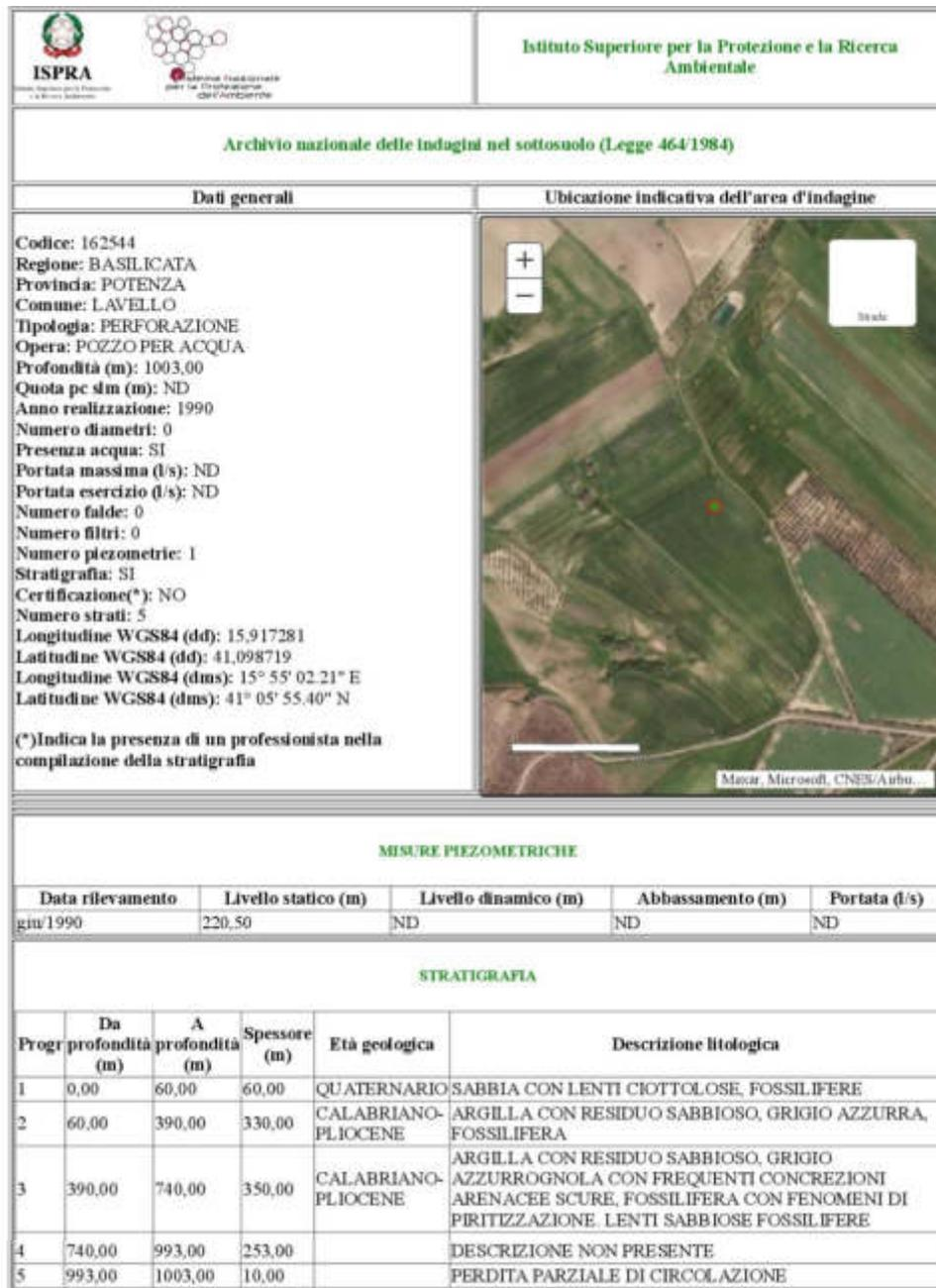
Fig. 8 – Stratigrafie di pozzo per acqua da archivio nazionale delle indagini del sottosuolo ISPRA
