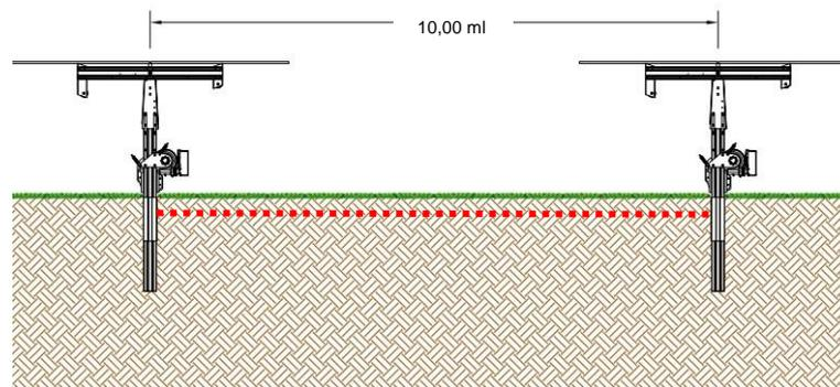
**Figura 8 – Distanza tra le singole file (tracker) di moduli fotovoltaici con indicazione della superficie che può essere utilizzata per la messa a coltura di prato stabile (linea tratteggiata rossa).**
