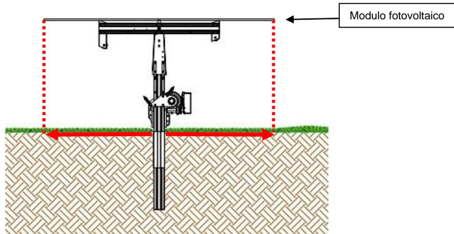
**Figura 6 – Area d’insidenza massima del modulo fotovoltaico raggiunta in posizione orizzontale (indicata con le frecce rosse)**
