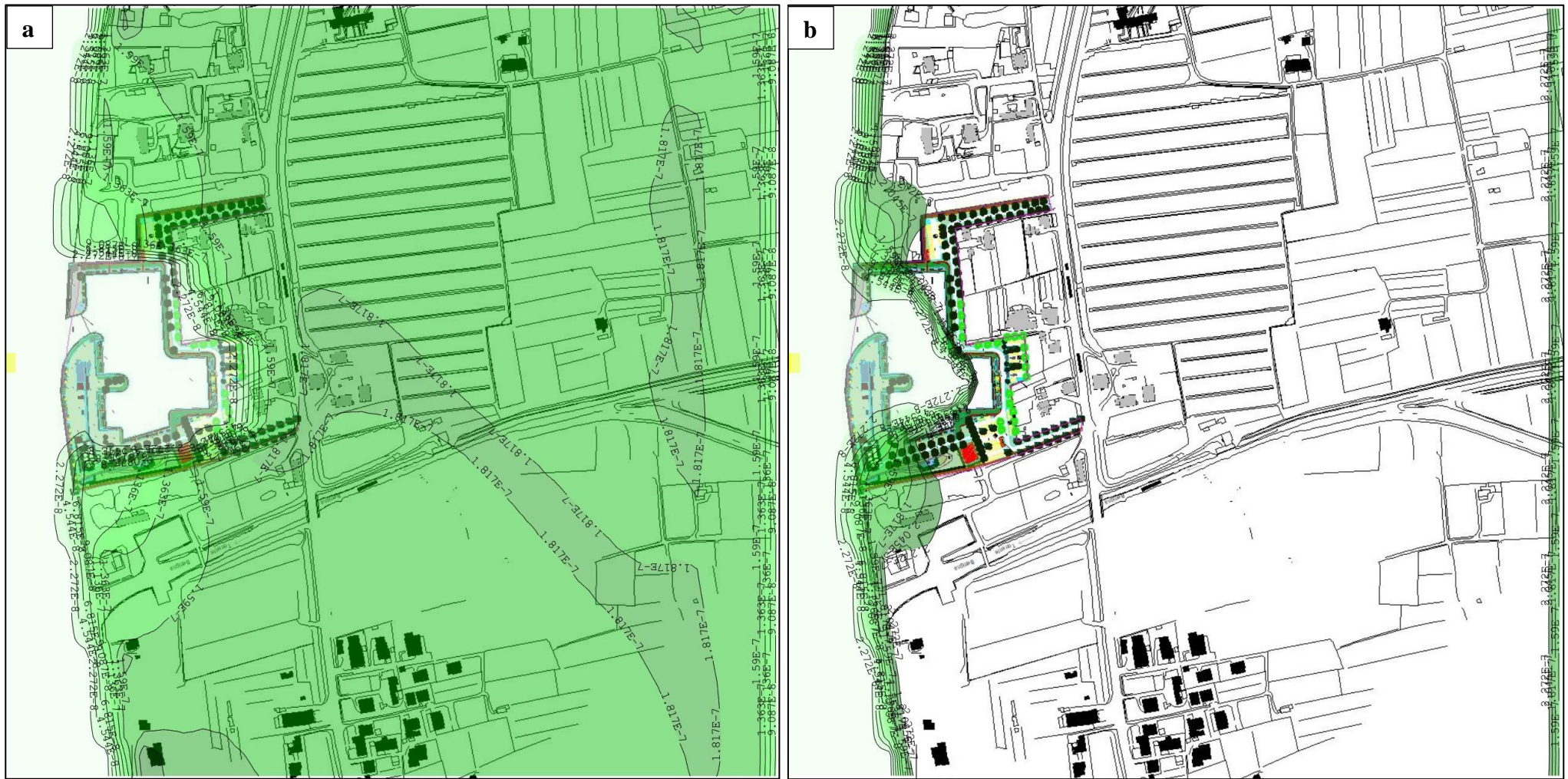
Figura 11. Flusso orizzontale (m 3 /s) nello stato di progetto (post-operam), con presenza di palancole a delimitare la superficie di scavo. a) Layer 2. b) Layer 3.
