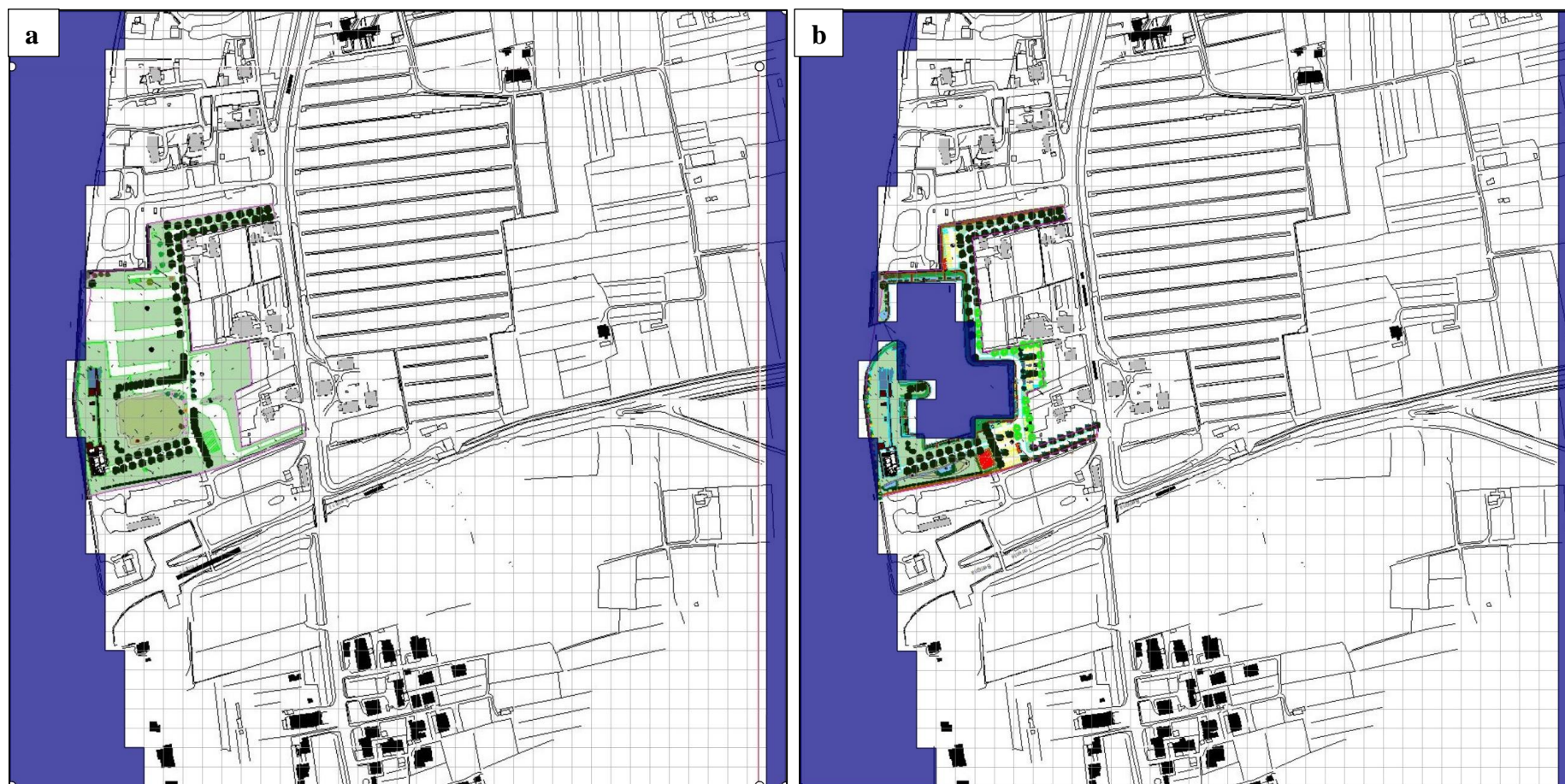
Figura 3. Set-up dei modelli in cui sono visibili la griglia del modello (piano x-y) e le condizioni al contorno (aree blu: IBOUND=-1 - constant head). a: stato attuale o ante-operam; b: stato di progetto o post-operam (presenza di scogliere e telo in HDPE intorno alla superficie di scavo).
