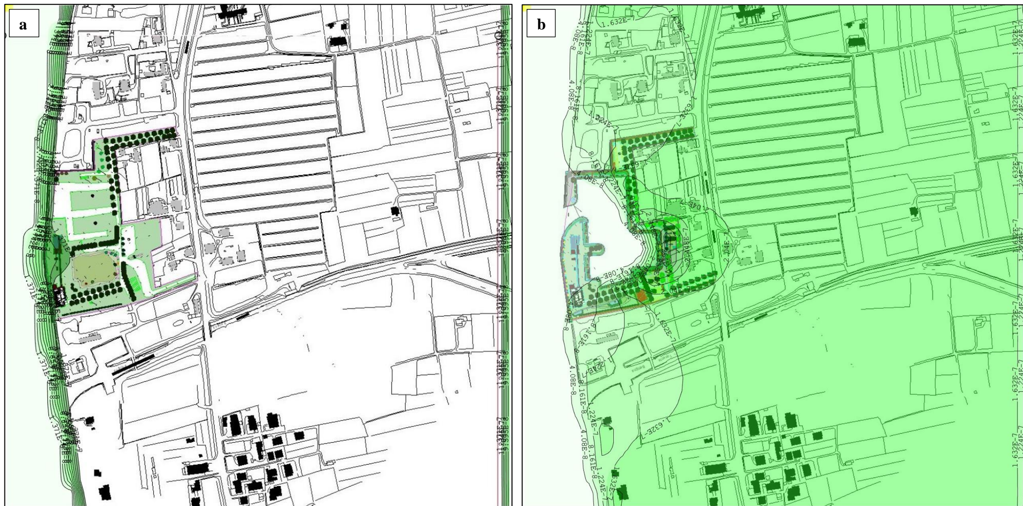
Figura 7. Flusso orizzontale (m 3 /s) nel layer 2. a) Stato attuale (ante-operam). b) stato di progetto (post-operam), con presenza di scogliere e teli in HDPE a delimitare la superficie di scavo.
