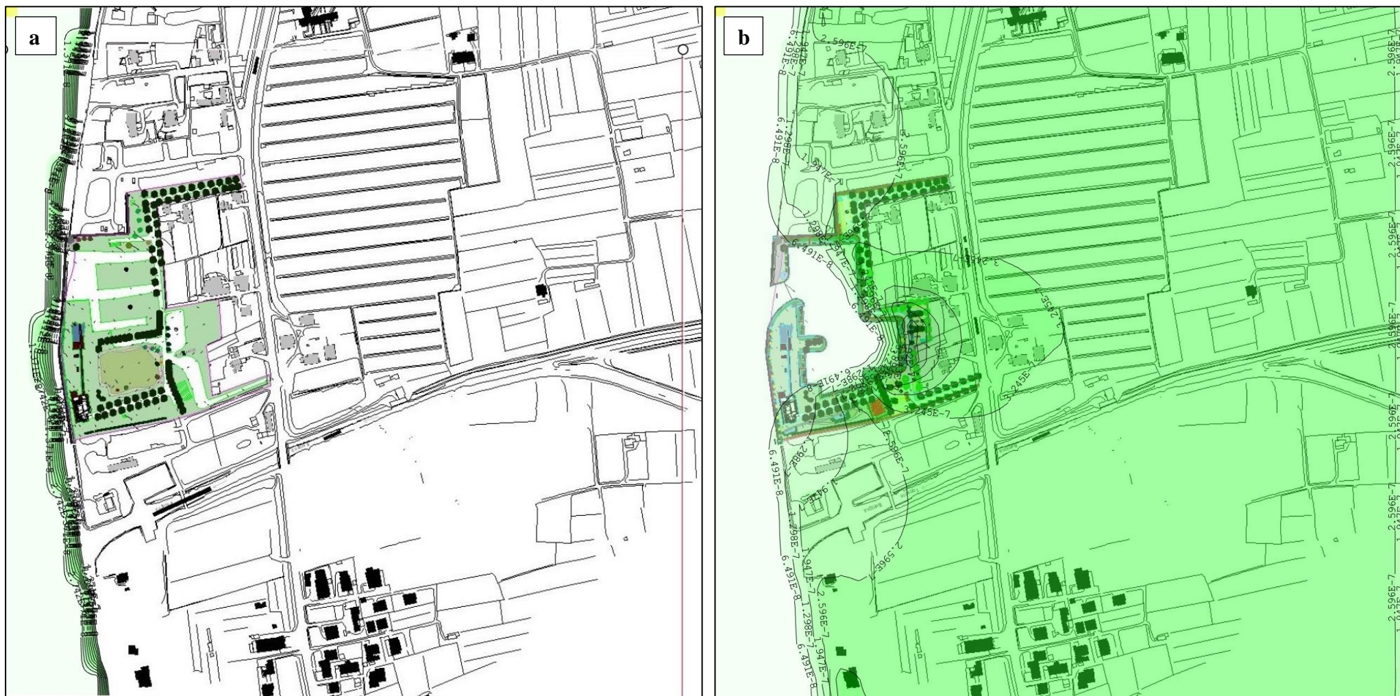
Figura 8. Flusso orizzontale ( m^3/s ) nel layer 3. a) Stato attuale (ante-operam). b) stato di progetto (post-operam), con presenza di scogliere e teli in HDPE a delimitare la superficie di scavo.
