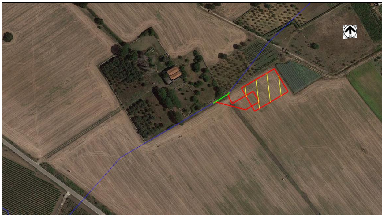
Figura 1.1/B – Stralcio immagine aerea con localizzazione DI PROGETTO dell'area dell'Intervento n.1 (opere in progetto in rosso, dismissione in verde, esistente in blu)
