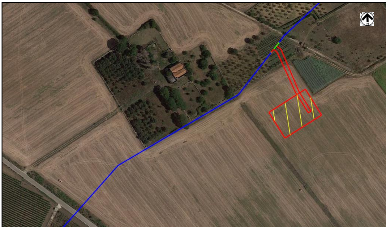
Figura 1.1/C – Stralcio immagine aerea con localizzazione della VARIANTE dell'area dell'Intervento n.1 (opere in progetto in rosso, dismissione in verde, esistente in blu)
