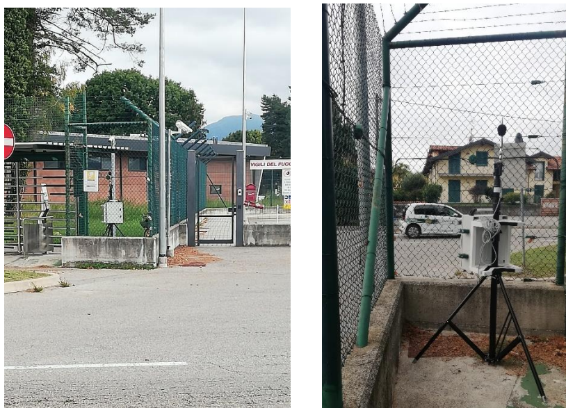
Figura 4.1 Stazione di misura per il rilievo del rumore stradale presso il punto M4 Gate Ispra
