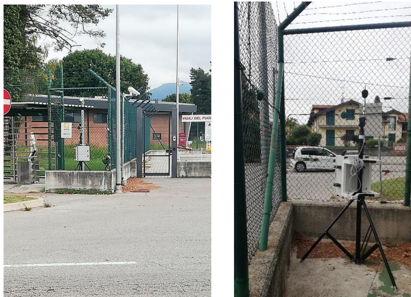
Figura 1 Stazione di misura per il rilievo del rumore stradale presso il punto M4 Gate Ispra
