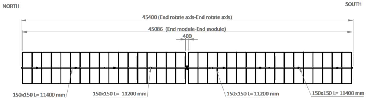
Figura 4-2: Struttura porta pannelli tipo Soltec 2x34
