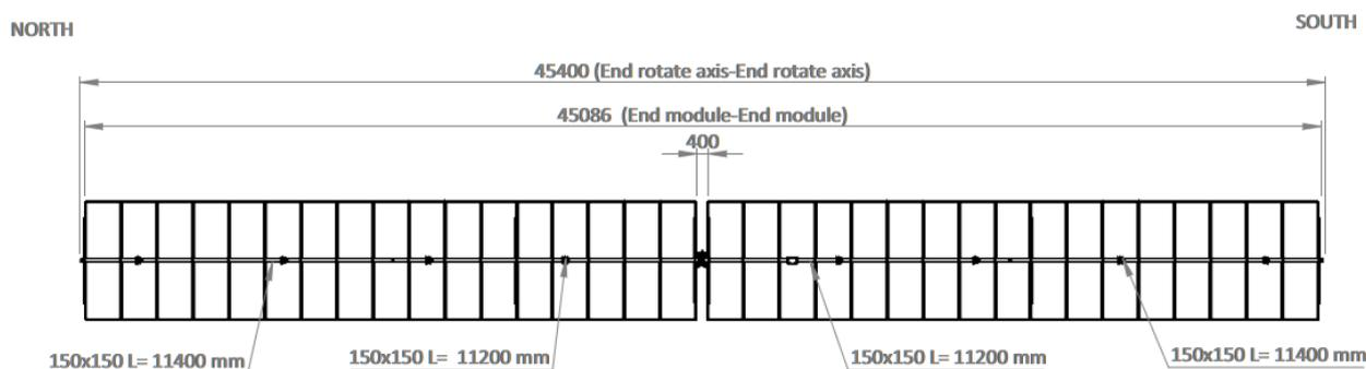
Figura 1-3: Struttura porta pannelli tipo Soltec 2x34
