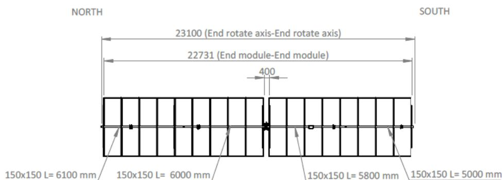
Figura 1-2: Struttura porta pannelli tipo Soltec 2x17
