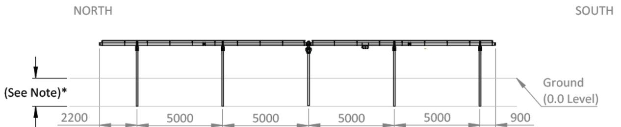
**Figura 4: Schema della struttura – vista longitudinale modulo 17x2**
