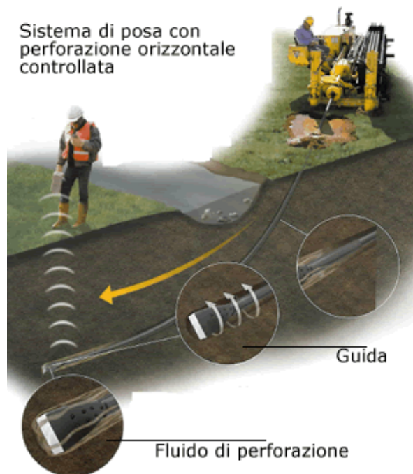
Figure 5-Sistema di trivellazione orizzontale controllata (T.O.C.).
