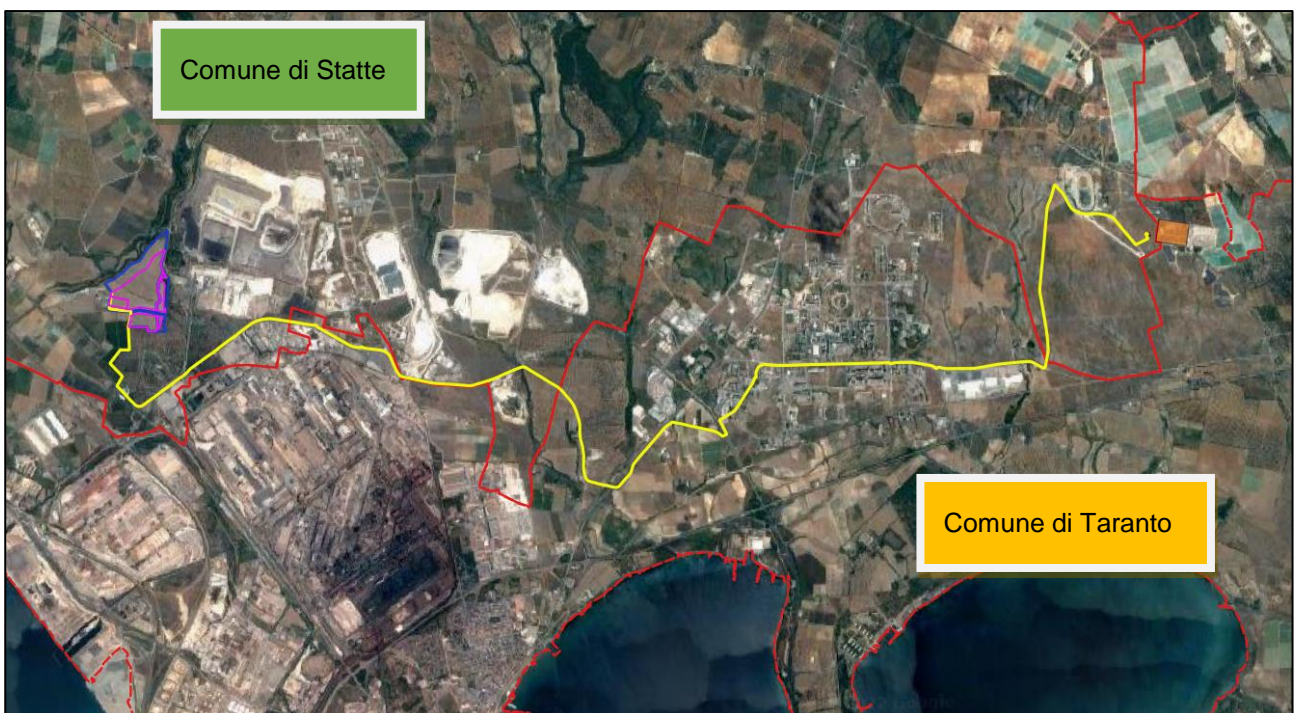
Figura 4-3: Inquadramento territoriale su Ortofoto del complesso del percorso del cavidotto di connessione MT (in giallo)
