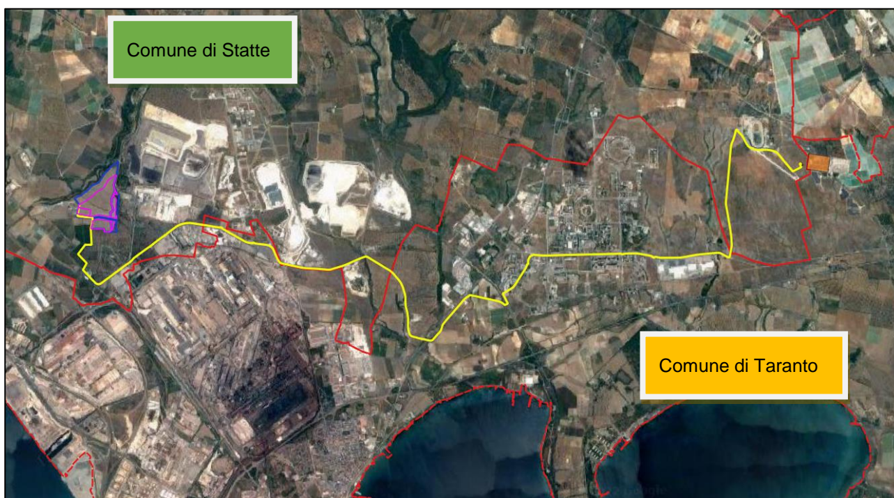
Figura 2-3: Inquadramento territoriale su Ortofoto del complesso del percorso del cavidotto di connessione MT (in giallo)
